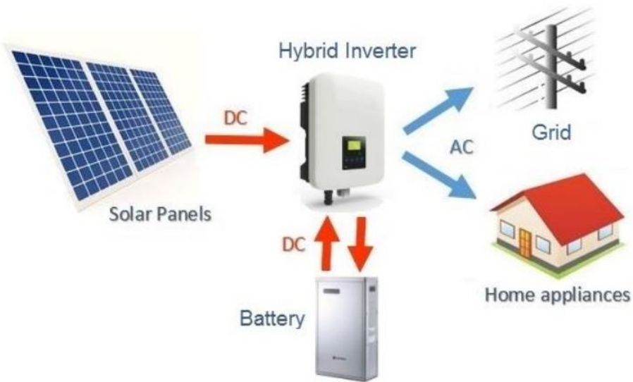
Slika 16. Hibridni fotonaponski sustav [12]
