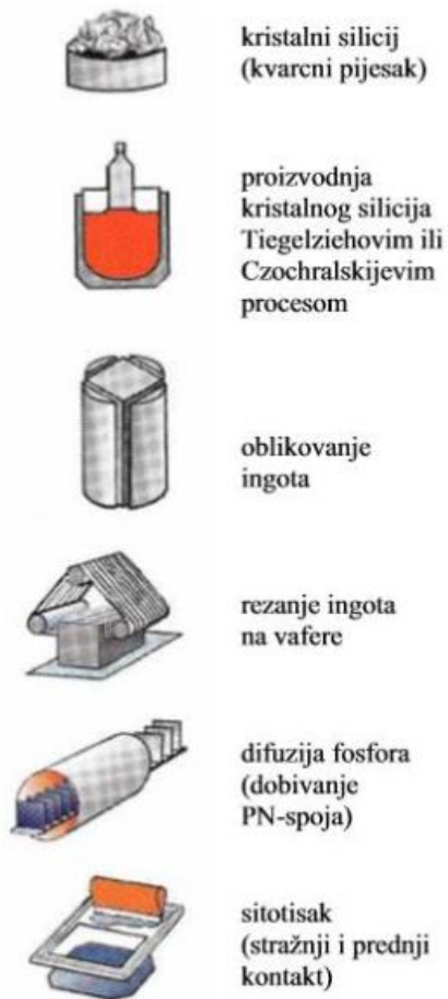
Slika 10. Postupak proizvodnje solarnih ćelija [8]
