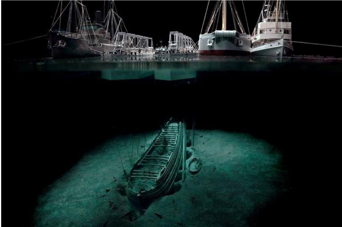
Slika 14. Model koji prikazuje metodologiju spašavanja „Vasa“ [14]
