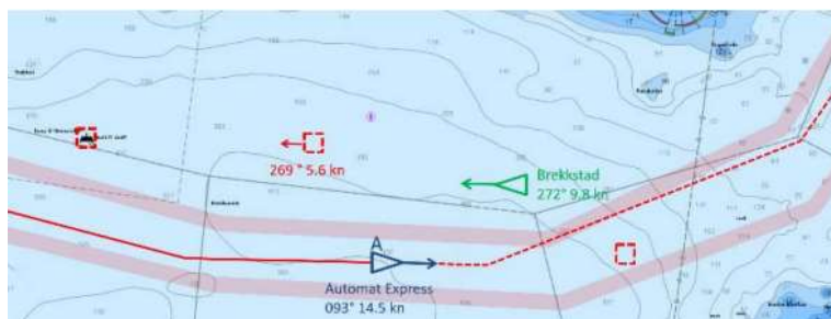
Slika 11. Prikaz autonomnog broda na ECDIS-u [13]
