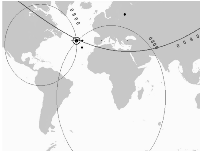
Slika 7. Astronomska pozicija dobivena korištenjem zenitnih udaljenosti [11]
