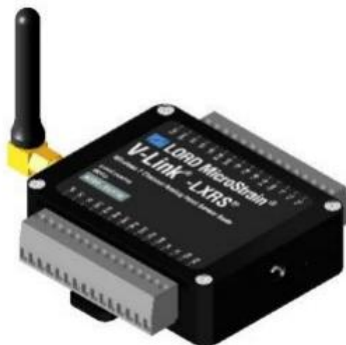
Slika 30. V-Link-LXRS bežični senzorski uređaj [8]
