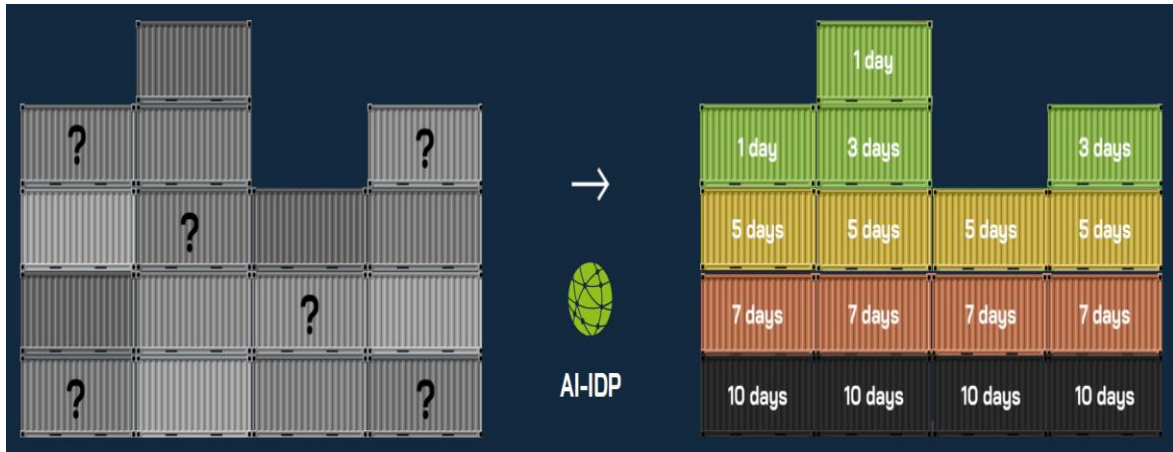
Slika 15. Prikaz metodologije slaganja kontejnera sa AI-IDP umjetnom inteligencijom
