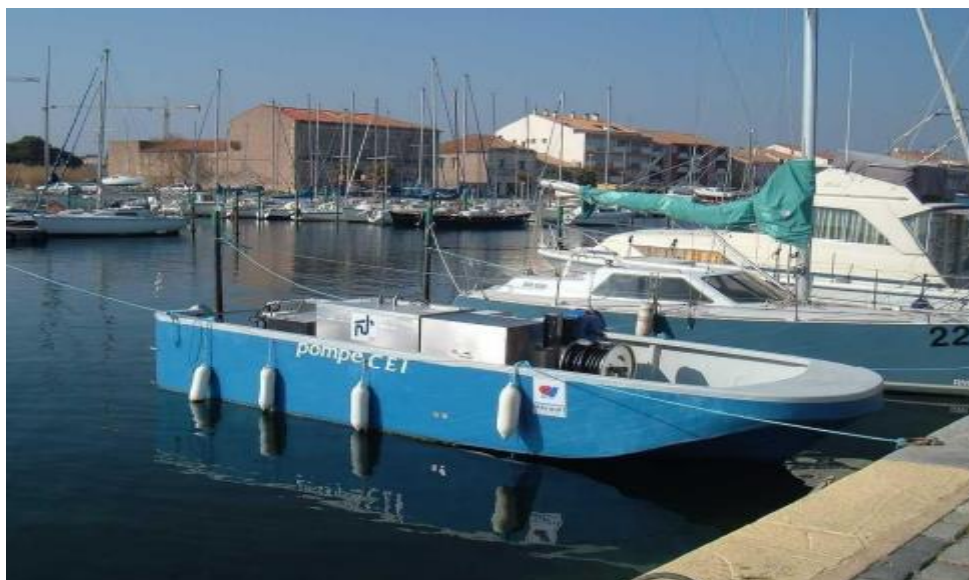
Slika 3. Plovilo za prikupljanje otpadnih voda [39]
