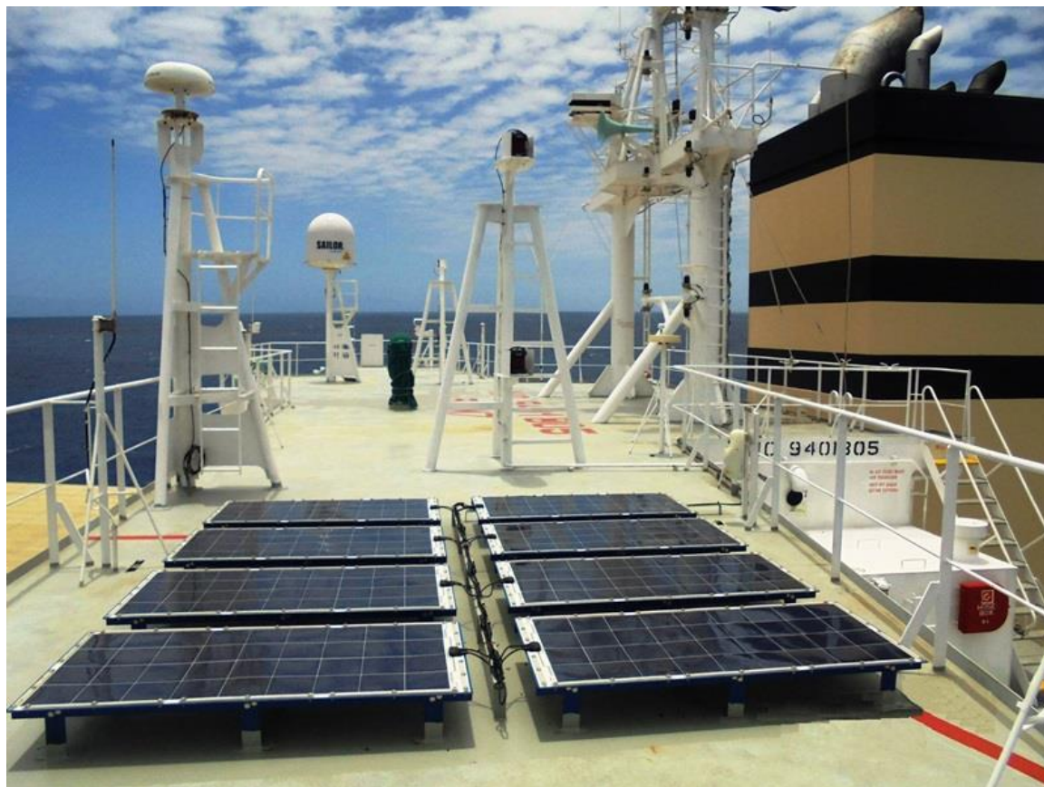
Slika 10. Solarni sustav na brodu
