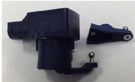
Slika 22. Potenciometar za regulaciju opterećenja [6]
