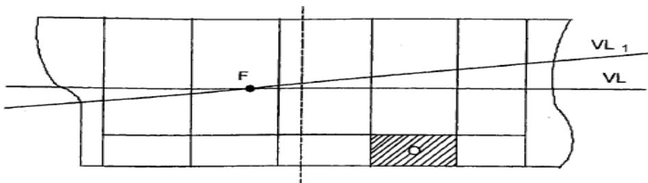
**Slika 7. Naplavljeno odjeljenje u spoju s vodom, ogradieno s gornje strane čvrstom palubom [2]**
