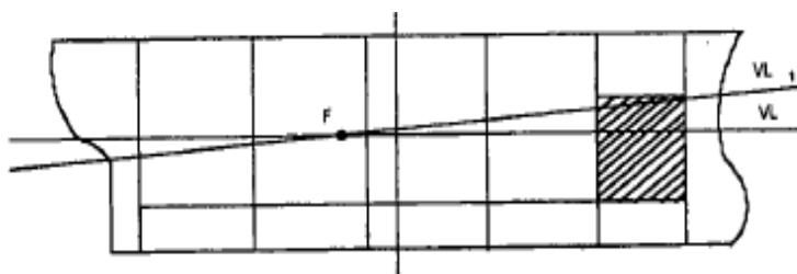
**Slika 8. Napavljeni odjeljenje nije u spoju s vodom niti je s gornje strane ogradieno čvrstom palubom [2]**
