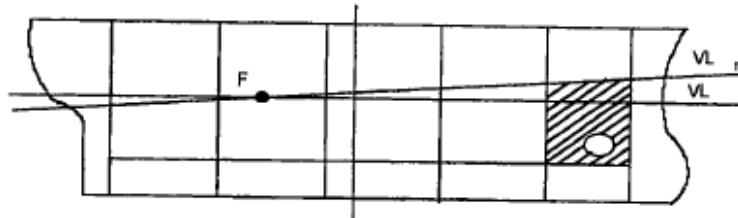
**Slika 9. Naplavljeno odjeljenje je u spoju s vodom a s gornje strane nije ogradieno čvrstom palubom [2]**
