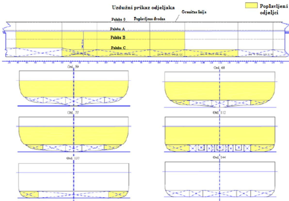
**Slika 20. Uzdužni i poprečni prikaz naplavljenih područja [3]**
