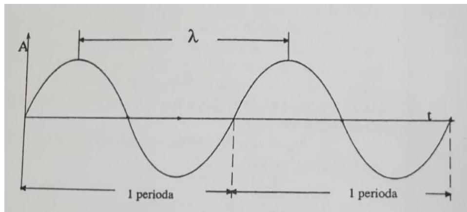
Slika 7. Vremenska ovisnost iznosa elektromagnetskog vala [4]
