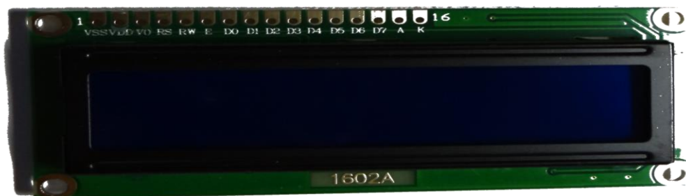
Slika 6. 1602A LCD module
