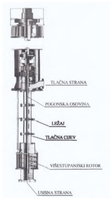
Slika 23 Uronjiva pumpa s dugom osovinom [24]
