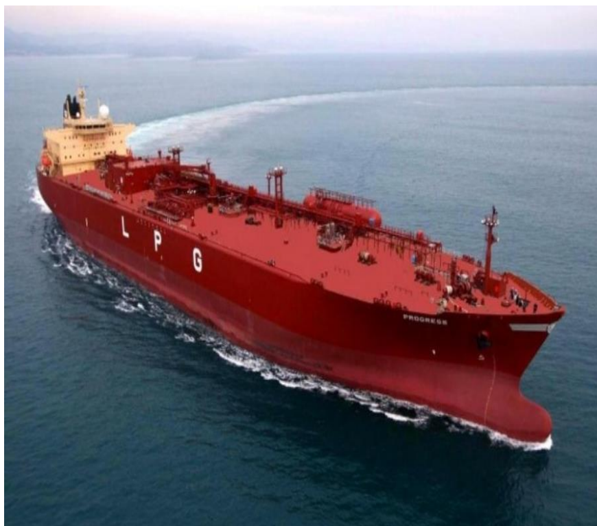
Slika 9 VLGC brod za prijevoz ukapljenog naftnog plina [7]
