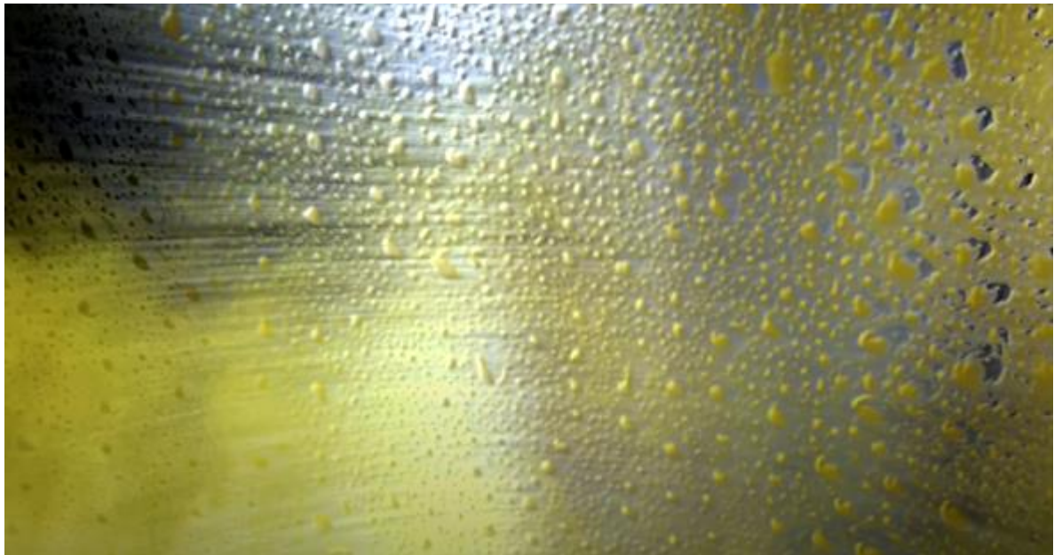
Slika 19. Kondenzacija na stjenkama košuljice cilindra [19]
