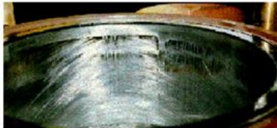
Slika 17. Pepelom oštećene površine košuljica [10]
