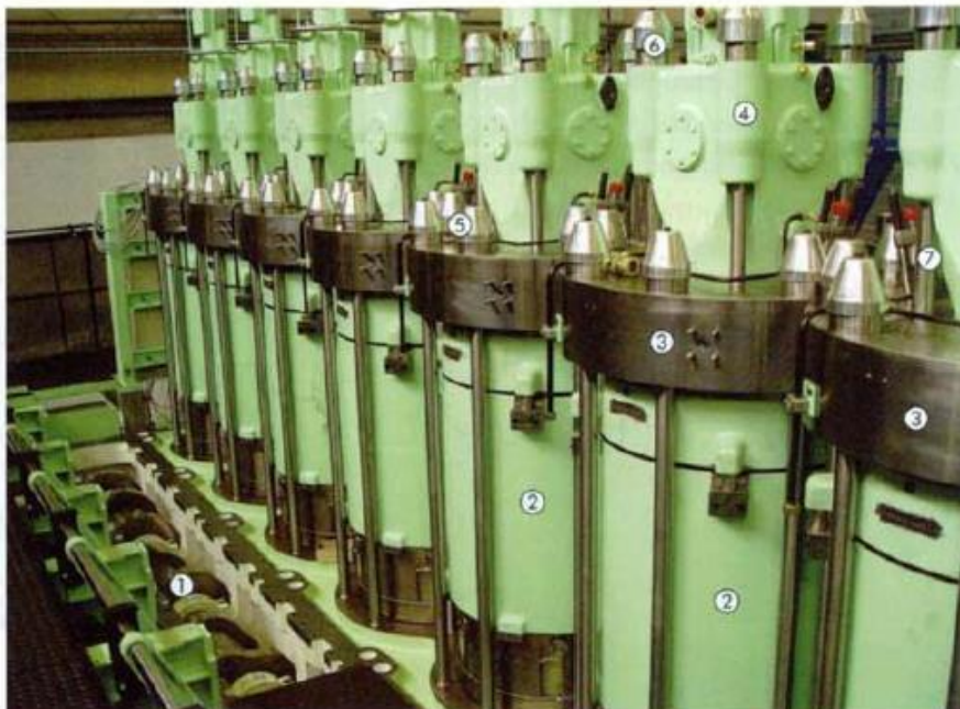
Slika 8. Cilindri, poklopci cilindra i ispušni ventili motora sa križnom glavom [1]
