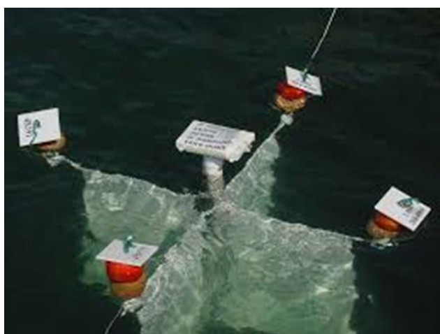
Slika 8. Langrangeova metoda – satelitski praćeni drifter [11]
