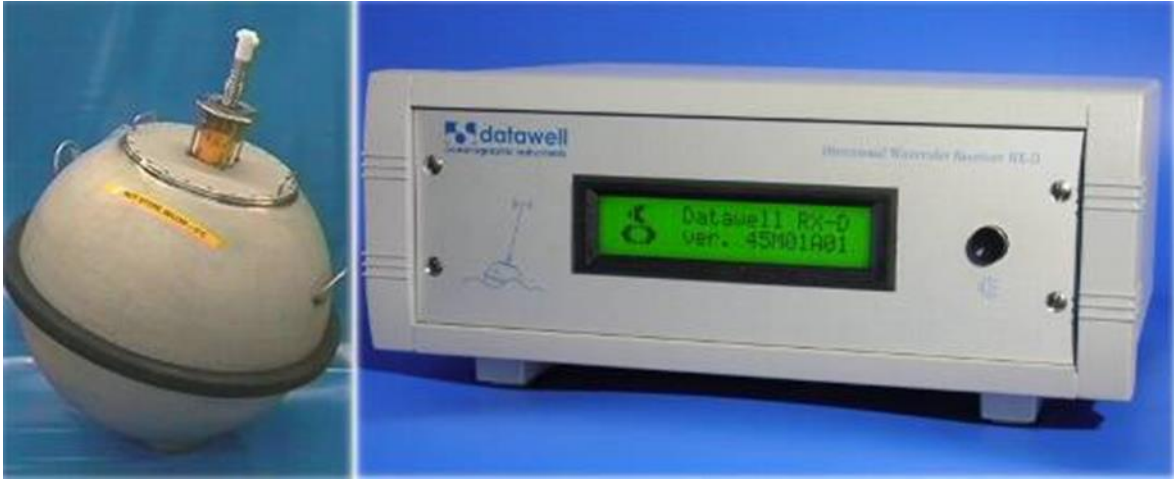
Slika 14. Mjerna plutača s odašiljačem i prijemna stanica valomjera tvrtke DATAWELL [16]
