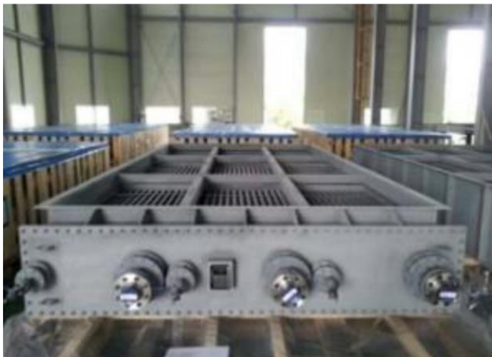
Slika 16. Zagrijač zraka za plinsku turbinu [20]
