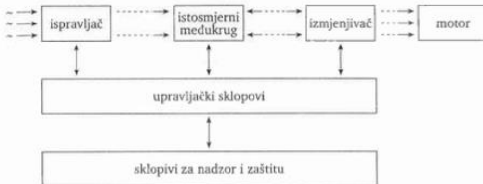
Slika 3. Pojednostavljeni prikaz sheme neizravnoga frekvencijskoga pretvarača [2]
