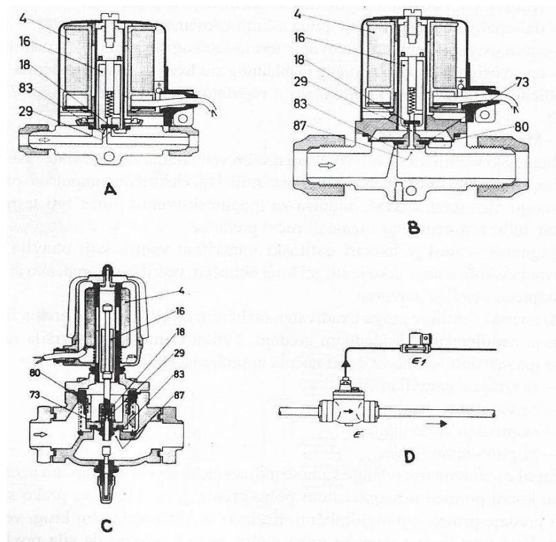
**Slika 4. Razne izvedbe magnetskih ventila [9]**
