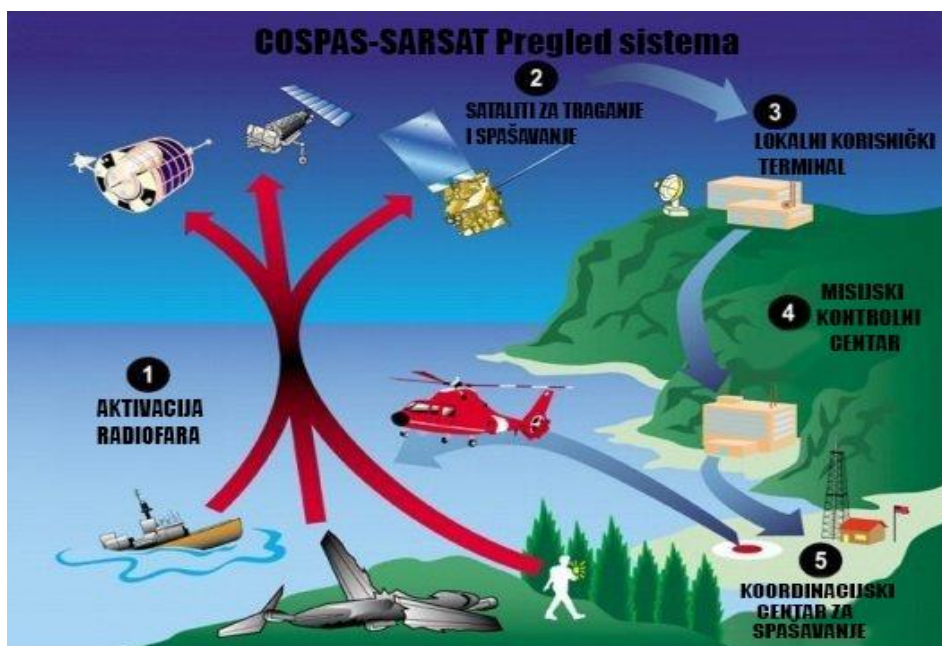
Slika 6. Princip rada COSPAS-SARSAT sustava [23]
