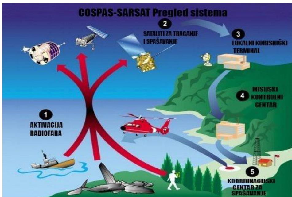
Slika 6. Princip rada COSPAS-SARSAT sustava [23]
