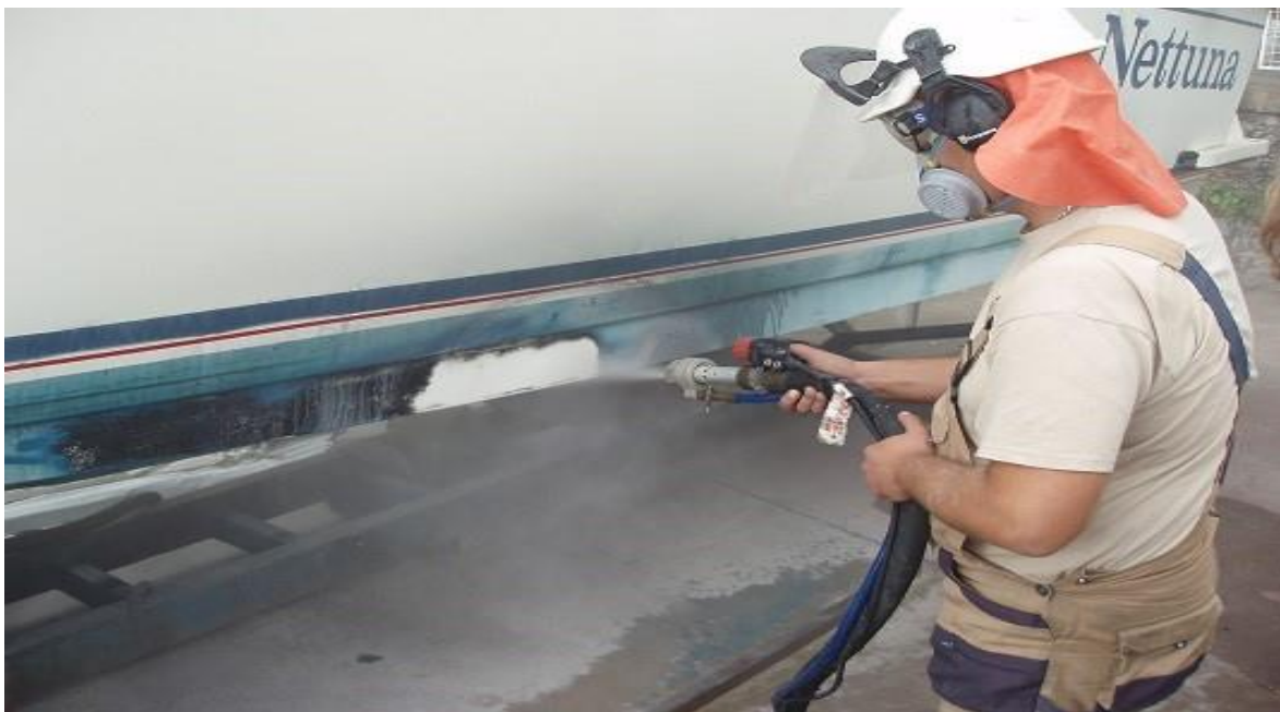
Slika 12. Pjeskarenje broskog trupa sodom [4]
