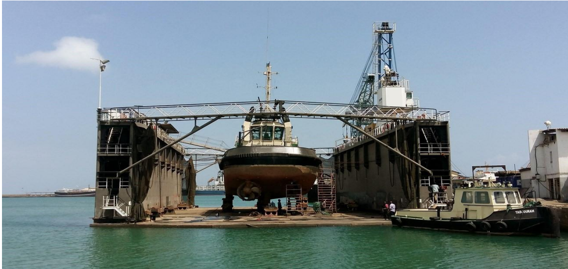
Slika 4. Brod u plutajućem doku [4]
