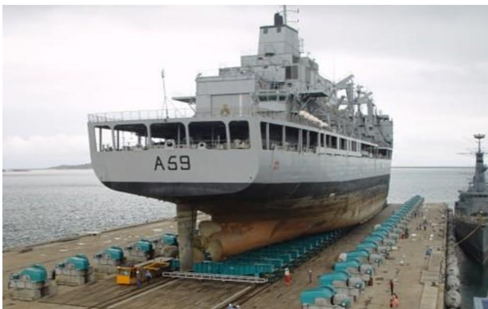
Slika 2. Brod u syncro-liftu [4]
