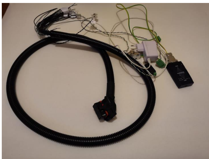
Slika 30. Pravilno spojen MOLEX CMC 98993 priključak s pretvaračima
