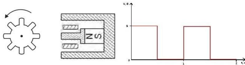
Slika 7 Mjerenje pomoću magnetne indukcije [1]
