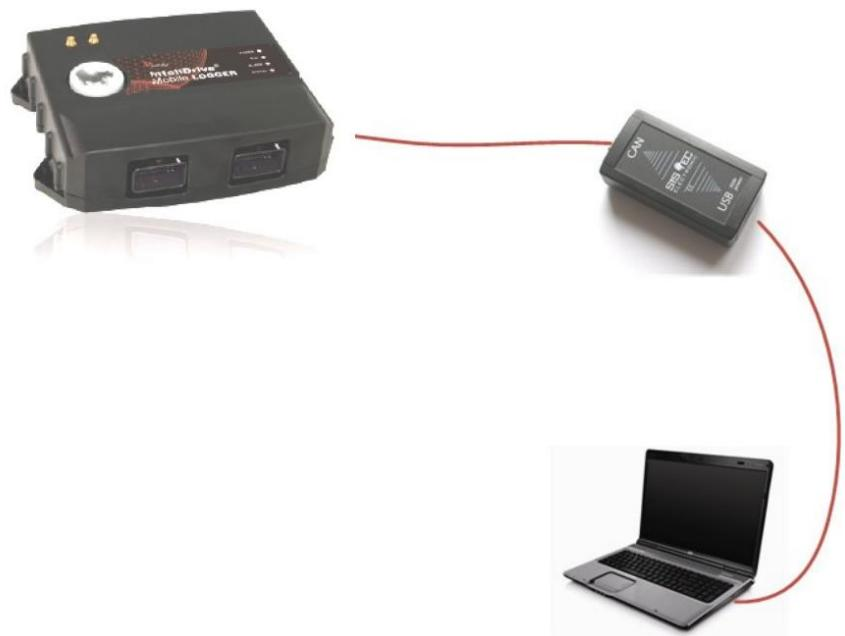
Slika 28. Shematski prikaz povezivanja računala s ID-Mobile-Logger-om pomoću CAN/USB pretvarača signala. [5]
