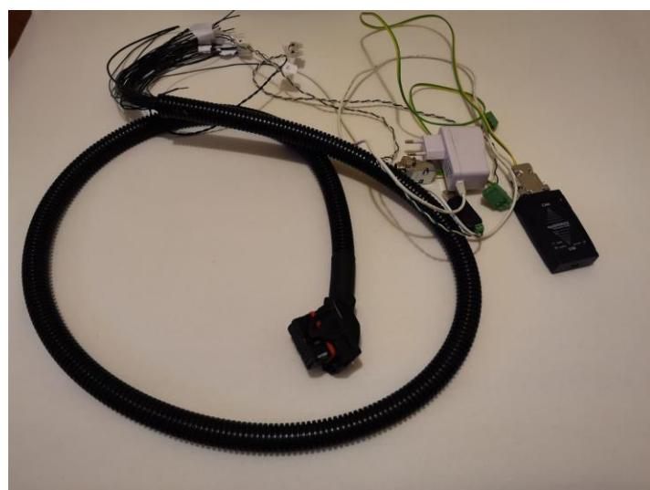
Slika 30. Pravilno spojen MOLEX CMC 98993 priključak s pretvaračima
