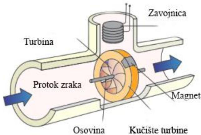
Slika 10. Mjerač protoka pomoću rotacijskog elemenata [11]
