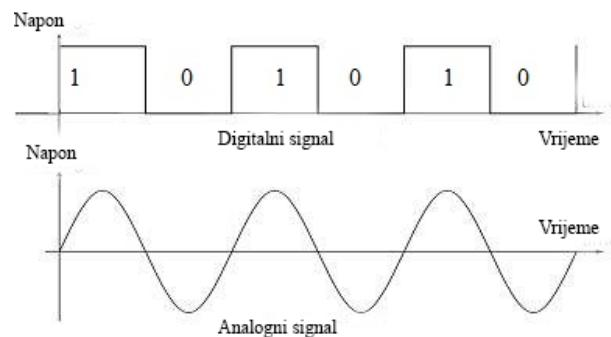
Slika 13. Razlika između digitalnog i analognog signala [8]
