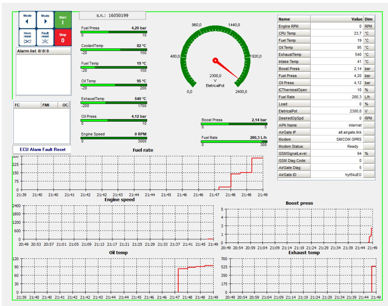
Slika 32. Rad motora i grafova pri 2300 o/min
