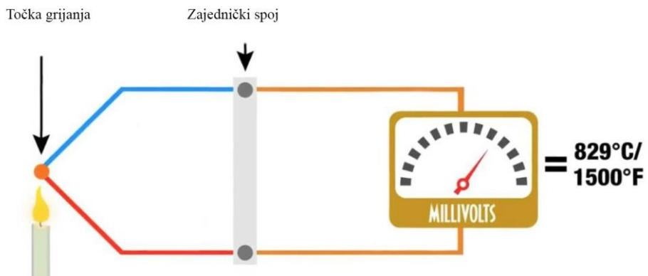
Slika 3. Shematski princip rada termometra sa termo - elementima [1]
