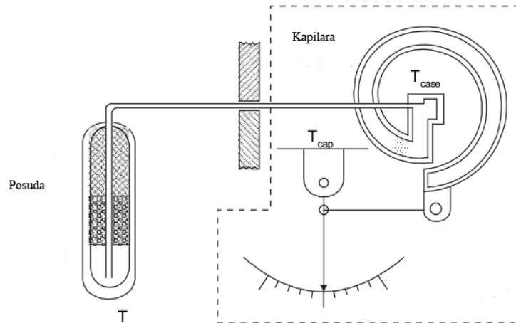
Slika 2. Termometar sa tekućinom [1]
