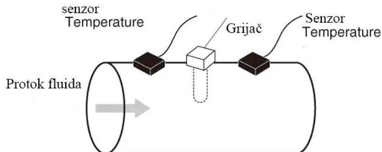
Slika 11. Shematski prikaz temperaturnog mjerača protoka [12]
