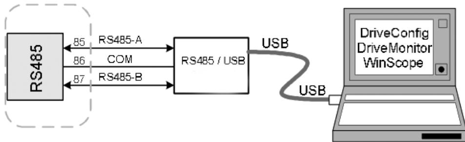
Slika 19. Shematski prikaz povezivanja[5]
