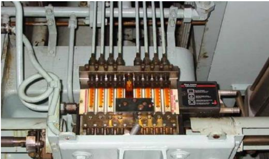
Slika 11 Mehanički podmazivač cilindarskih košuljica [16]
