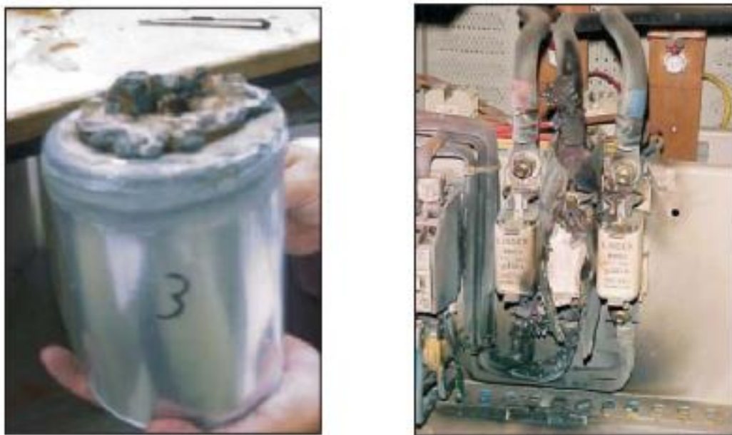
Slika 17. Posljedice rezonancije na frekvencijama viših harmonika [6]
