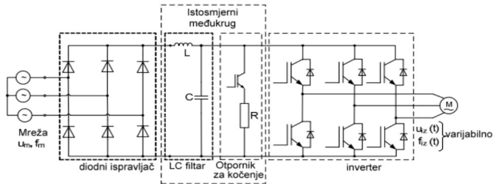
Slika 11. Shema frekvenčnog pretvarača [7]
