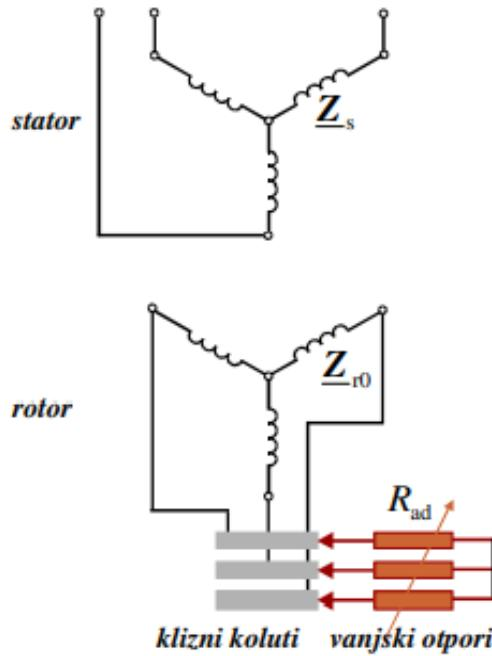
**Slika 3. Shematski prikaz klizno-kolutnog asinkronog motora [2]**
