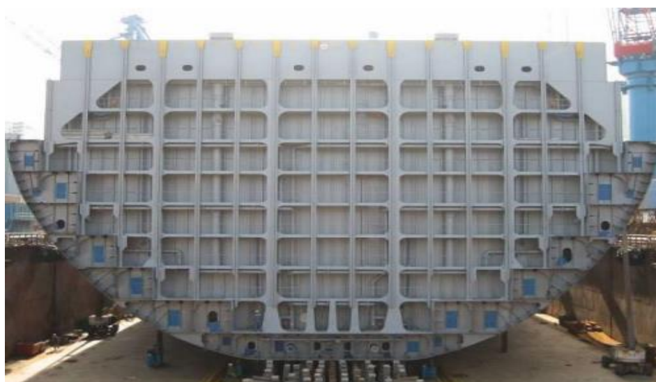
Slika 17. Nepropusna pregrada za prijevoz spremnika [1]
