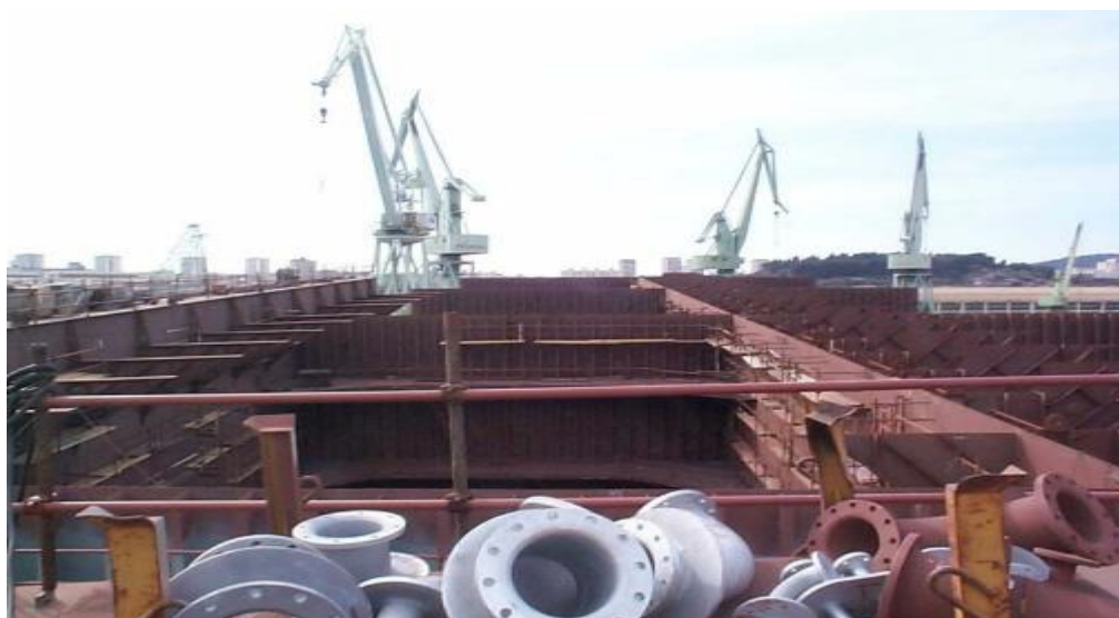
Slika 19. Poprečne i uzdužne pregrade [1]
