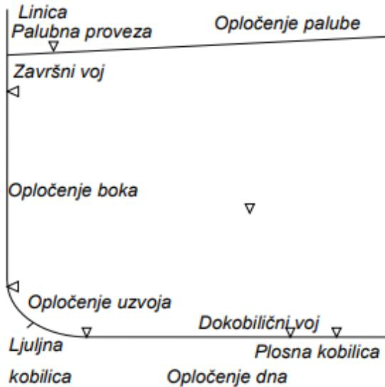
**Slika 23. Izvedba vanjske oplate [13]**
