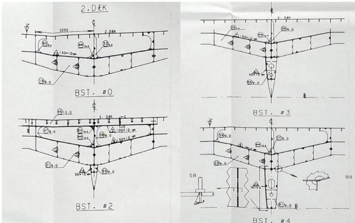
**Slika 42. Uzdužni elementi čvrstoće [27]**
