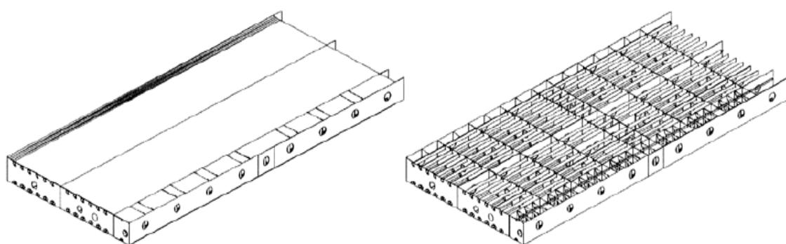
Slika 14. Dvodno u uzdužnom sustavu gradnje [1]
