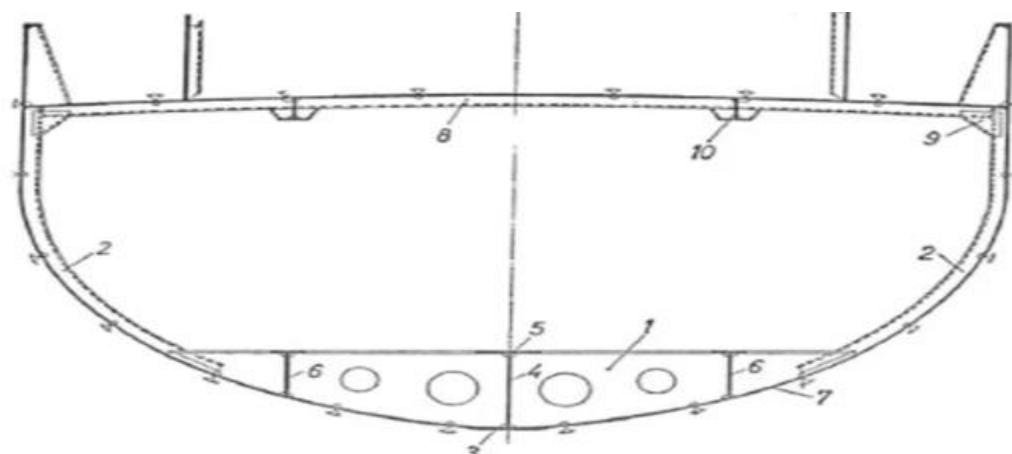
Slika 13. Jednostruko dno u poprečnom sustavu gradnje [13]
