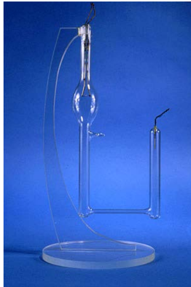
Slika 3. Staklena lampa za definiranje metra [17]
