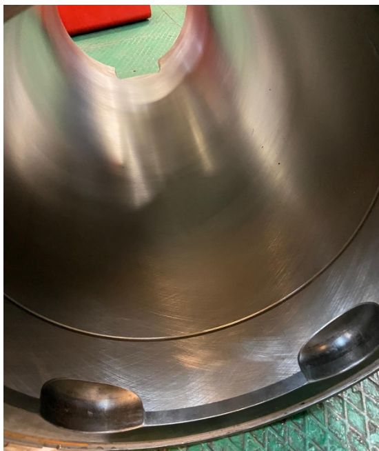
Slika 21. Honirana površina košuljice cilindra četverotaktnog motora [4]
