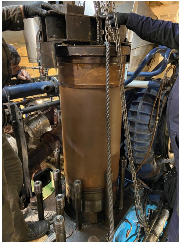
Slika 7. Stvarni prikaz vanjske strane košuljice cilindra [4]
