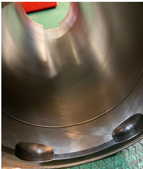
Slika 21. Honirana površina košuljice cilindra četverotaktnog motora [4]
