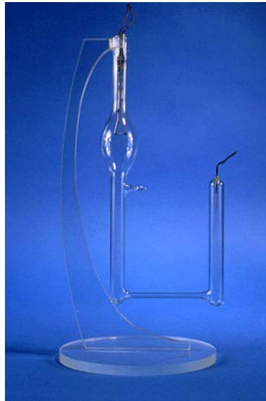
Slika 3. Staklena lampa za definiranje metra [17]
