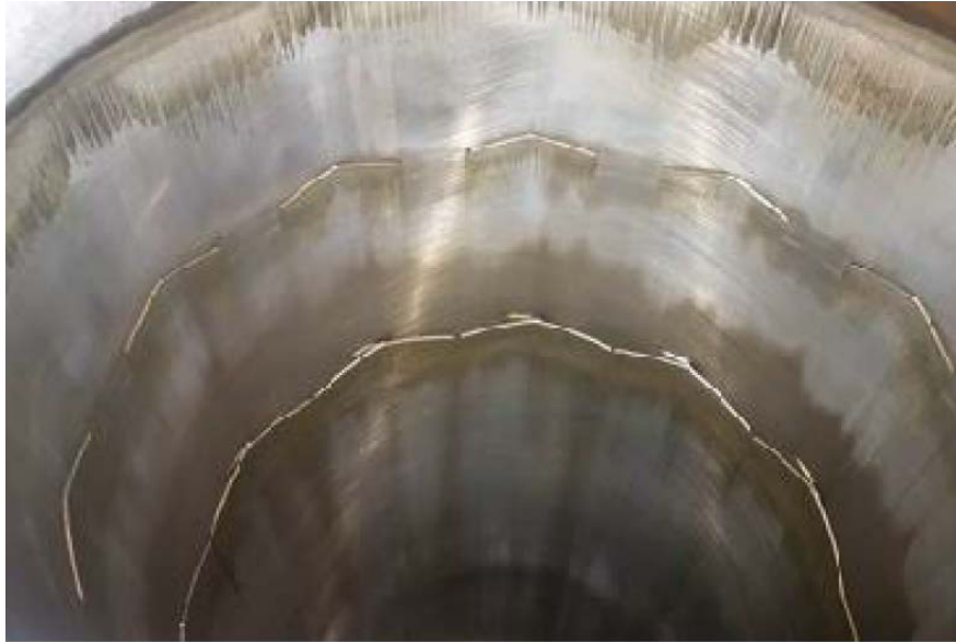
Slika 20. Unutarnji izgled košuljice cilindra [3].
