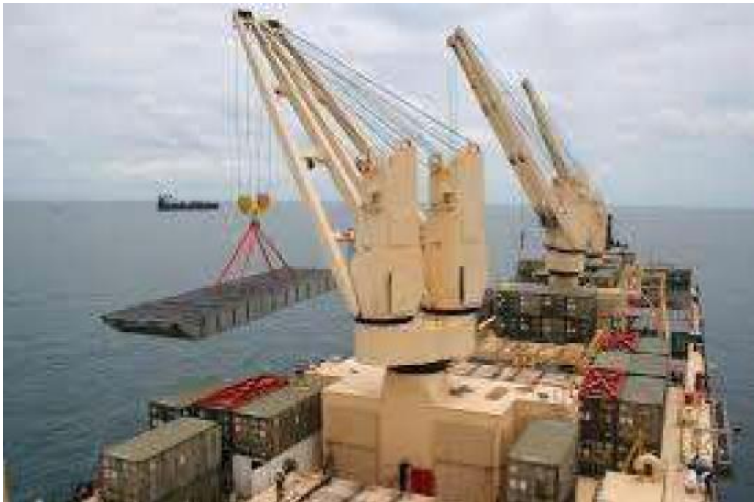
Slika 9. Prekrcaj tereta brodskim dizalicama (Prema: Ivošević, Špiro, Održavanje i bezbjednost broda , 2016.)
