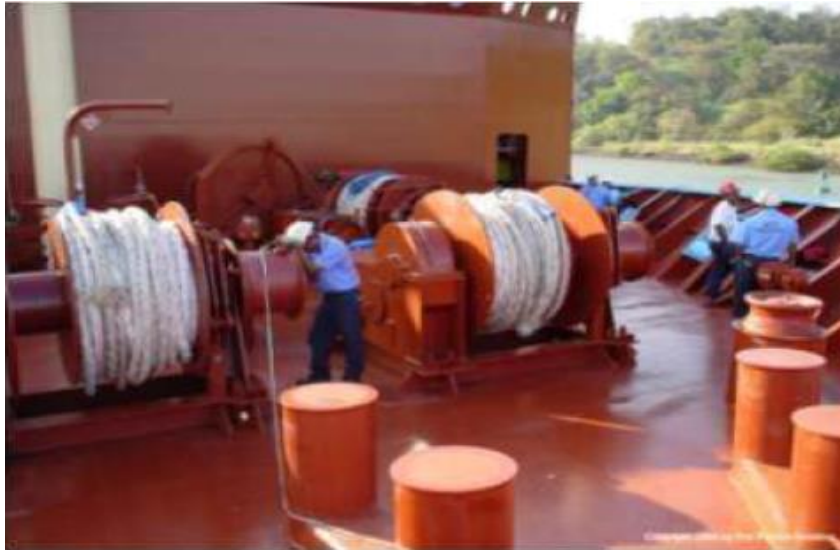
Slika 7. Održavanje konopa na priteznom vitlu (Prema: Ivošević, Špiro, Održavanje i bezbjednost broda , 2016.)
