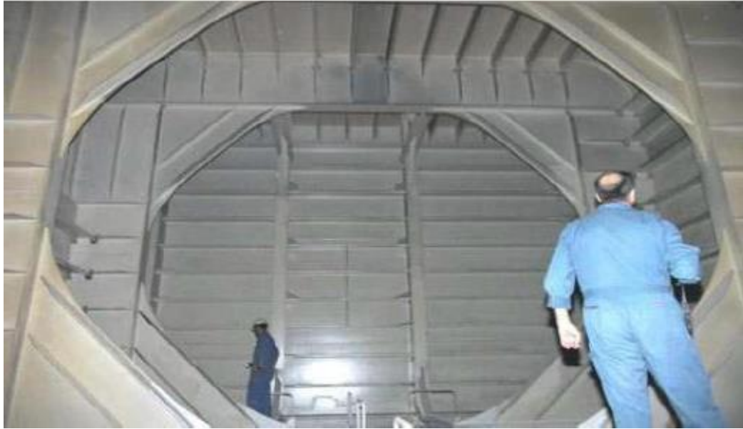
Slika 15. Vizualni pregled tankova (Prema: Ivošević, Špiro, Održavanje i bezbjednost broda , 2016.)
