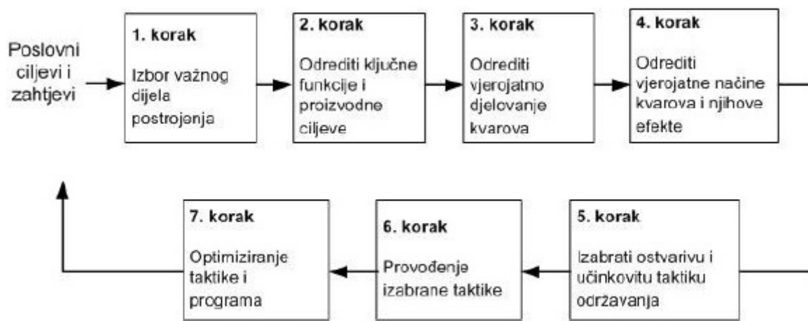
Slika 5. : Pregled RCM procesa (Prema: Šegulja, Bukša i Tomas, Održavanje brodskih sustava , 2009.)
