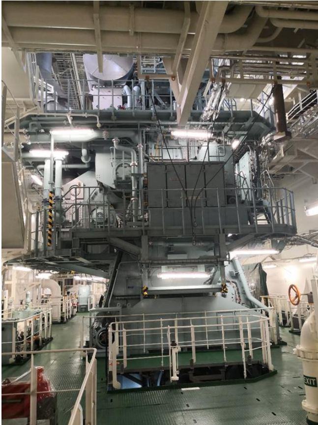
Slika 16. ME-GI motor u strojarnici LNG broda
