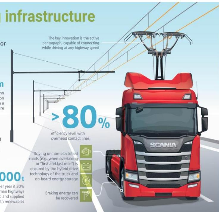
Slika 13 Siemensov e-Highway - Elektrificirani cestovni teretni promet [58]
