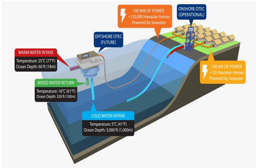
Slika 8 Princip rada OTEC generatora [51]
