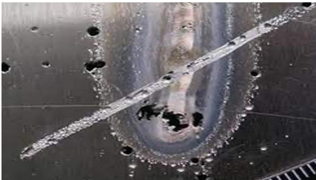
**Slika 28. Rupičasta korozija u cijevi [5]**
