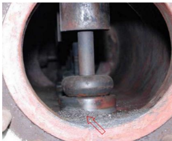
Slika 30. Kamenac u cjevovodu [23]
