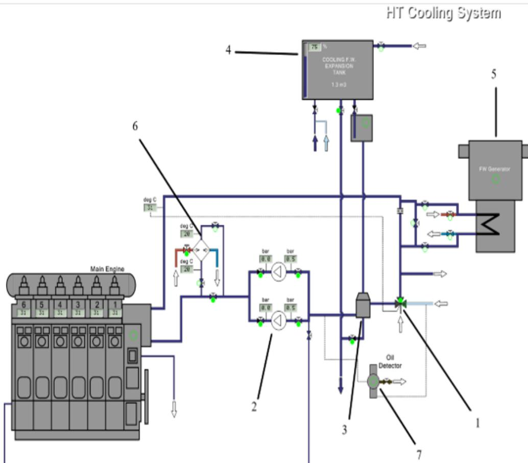
**Slika 3. Dijagram sustava rashladne vode visoke temperature [4]**
