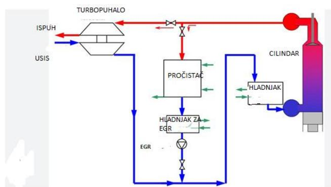
Slika 15. Prikaz sistema za recirkulaciju ispušnih plinova [32]
