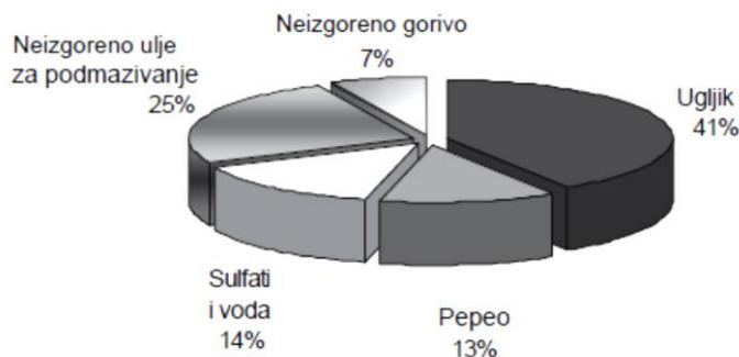
**Slika 5. Shematski prikaz sastava emisije čestica i čade velikih dvotaktnih sporokretnih motora [15]**
