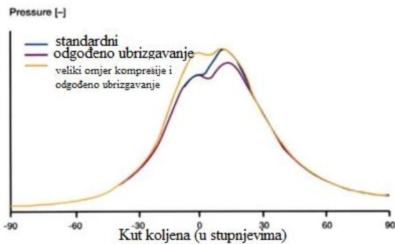
**Slika 13. Tlak u cilindru u slučaju standardnog omjera kompresije i povećane kompresije s odgodenim vremenom ubrizgavanja [27]**
