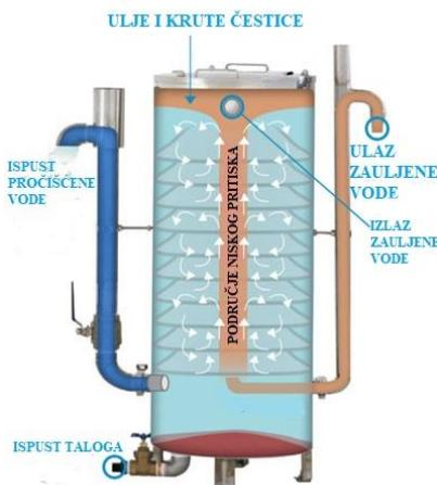
**Slika 9. Gravitacijski separator ulja [21]**
