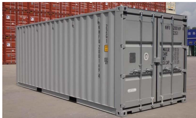
Slika 1. Primjer standardnog TEU kontejnera
