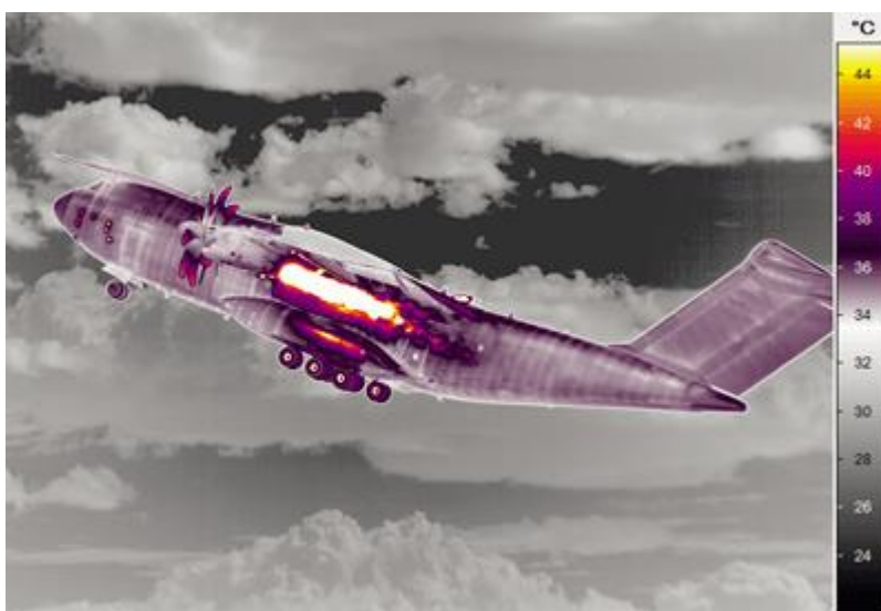
Slika 8. Termografski snimak zrakoplova u letu [6]
