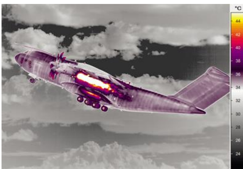
Slika 8. Termografski snimak zrakoplova u letu [6]
