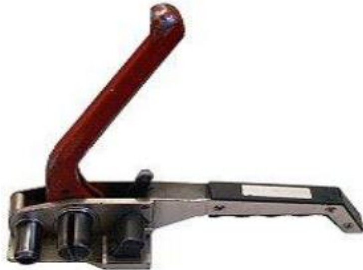
Slika 48. Jedan od tipova zatezača za sintetičke brage [8]
