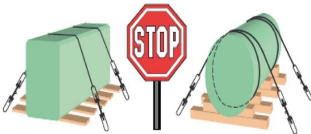
Slika 58. Zabranjeni način korištenja čelične užadi [28]
