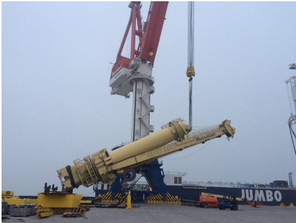
Slika 70. Podizanje palubne dizalice – Fairmaster [2]
