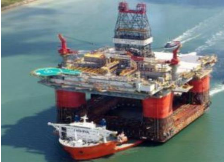
Slika 25. Brod Blue Marlin pri transportu platforme Thunder [17]
