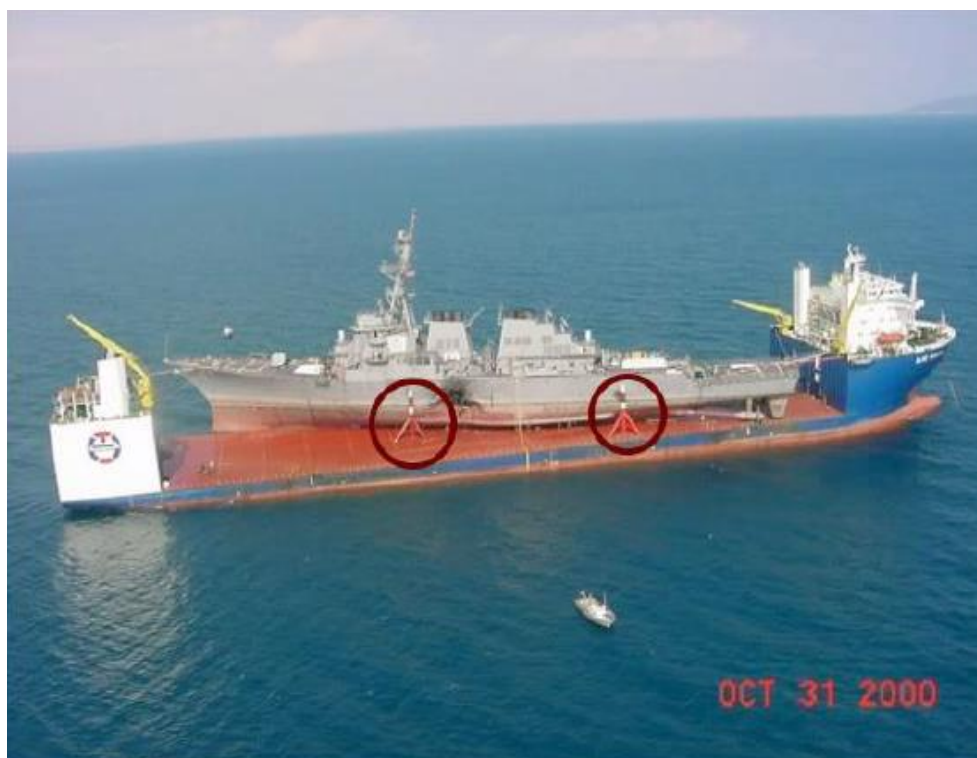
Slika 27. Brod Blue Marlin pri transportu oštećenog broda Američke ratne mornarice iz Adenskog zaljeva u SAD [14]
