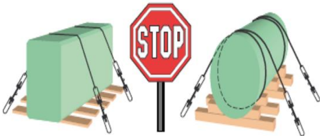
Slika 58. Zabranjeni način korištenja čelične užadi [28]
