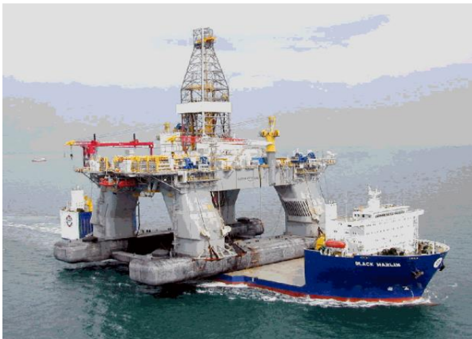
Slika 21. Brod Black Marlin pri transportu platforme iz Južne Koreje u Meksički zaljev [22]
