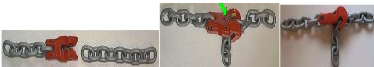
Slika 46. Skraćenje lanca sa specijalnom kukom zvanom kanda i osiguravajućom polugom [8]
