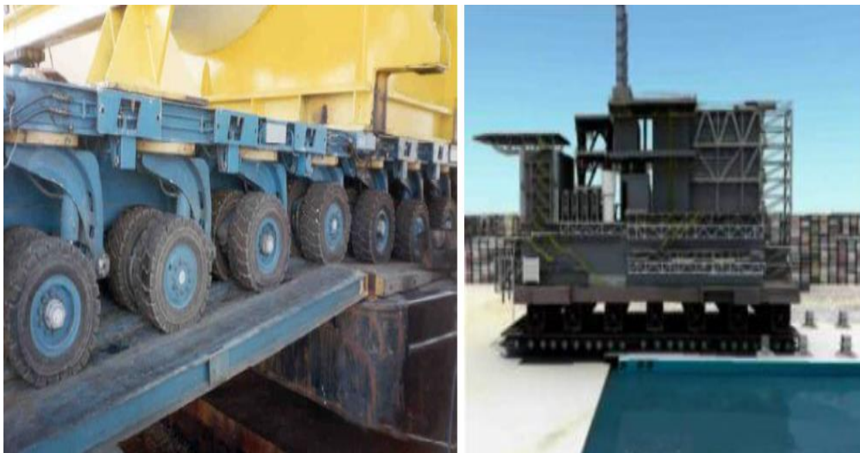
Slika 19. Ukrcaj Off-Shore konstrukcije preko krmene rampe pomoću hidrauličkog trilera podesivog po visini [7]
