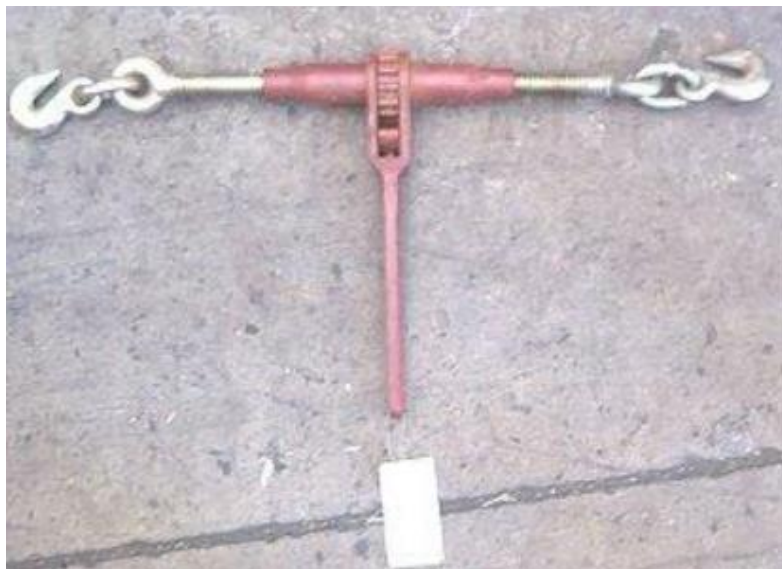
Slika 50. Stegač napravljen od čelika visoke čvrstoće sa karikom lanca i kukom na krajevima [8]
