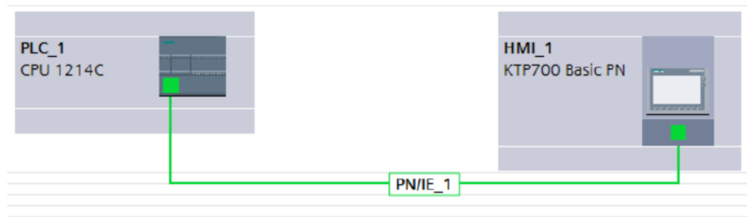
Slika 17: Povezani PLC uređaj i HMI panel [20]
