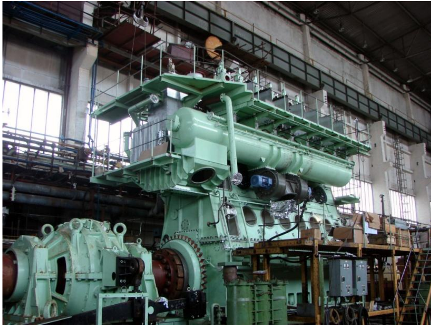
Slika 8. Sporohodni dizel motor [21]
