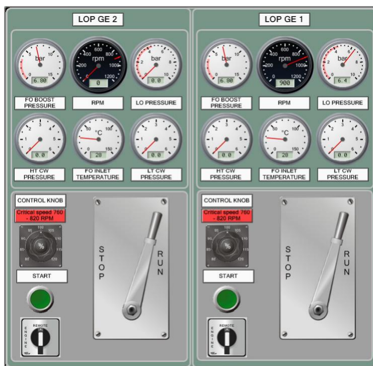
Slika 15. Operacijski panel za upravljanje dizel generatorom [3]
