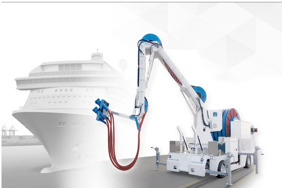
Slika 3. Priključak za kopno [7]
