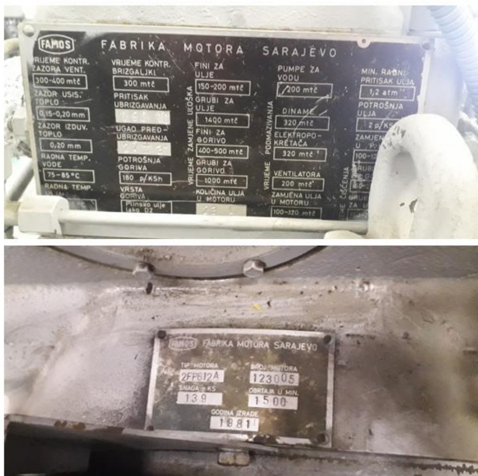
Slika 17. Tehnički podaci dizelskog motora marke FAMOS
