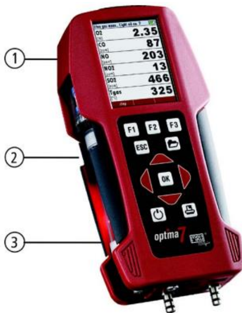
Slika 10. Prikaz Optima 7 NDIR mjernog uređaja [16]
