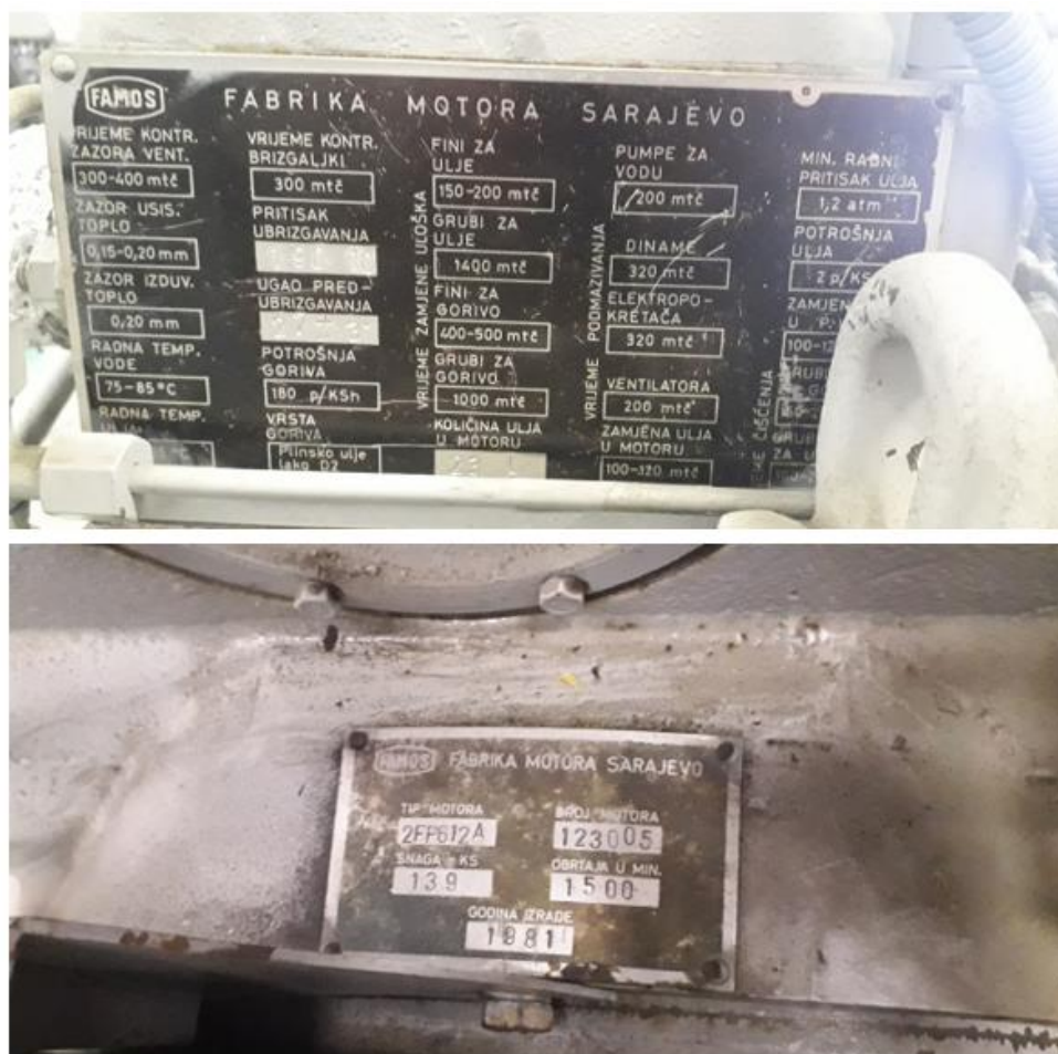
Slika 17. Tehnički podaci dizelskog motora marke FAMOS
