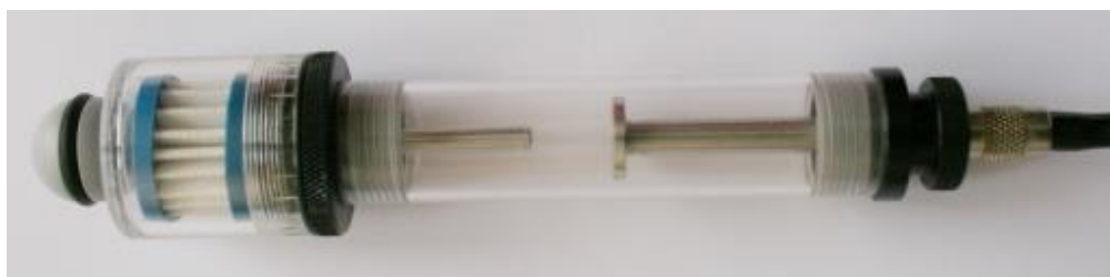
Slika 12. Odvajač kondenzata na uređaju Optima 7 NDIR [16]
