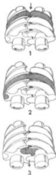
Slika 11. Radni taktovi kompresora [11]
