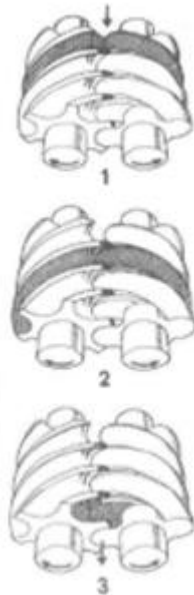
Slika 11. Radni taktovi kompresora [11]
