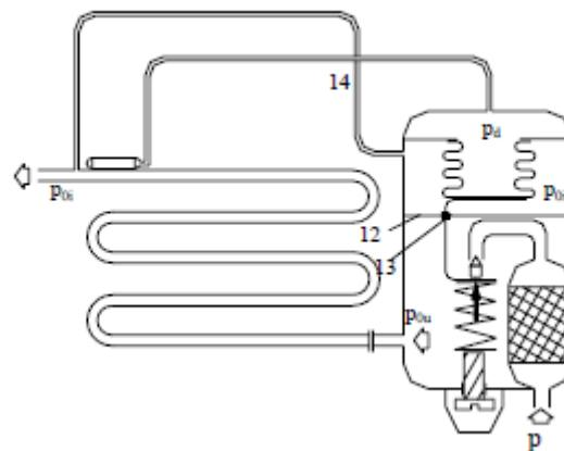
Slika 20. Termoekspanzijski ventil s vanjskim izjednačavanjem [6]
