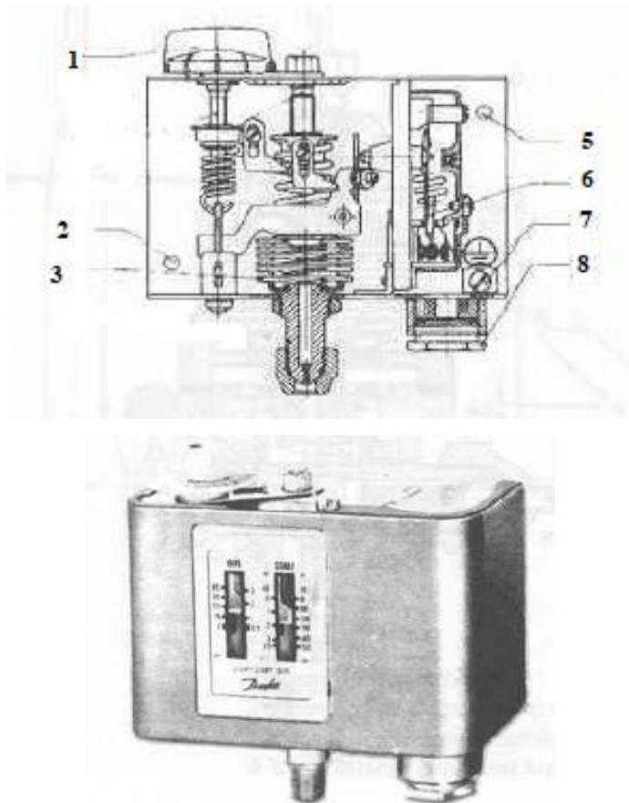
**1-kolut s glavom za za prilagodavanje, 2, 5-rupa za pričvršćenje, 3-niskotlačna membrana, 6-priklučak za preklapanje, 7-uzemljenje, 8-priklučak za električni kabel.**
