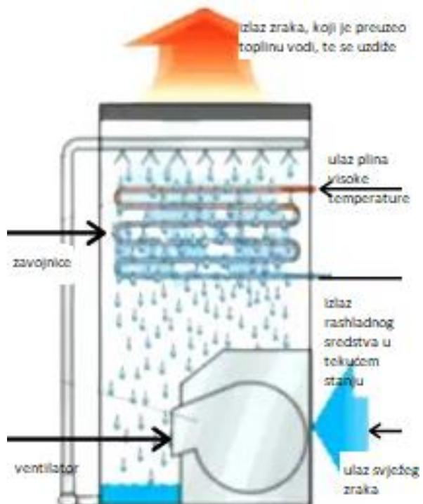
Slika 16. Kondenzator isparivačkog tipa – kombinirani [4]
