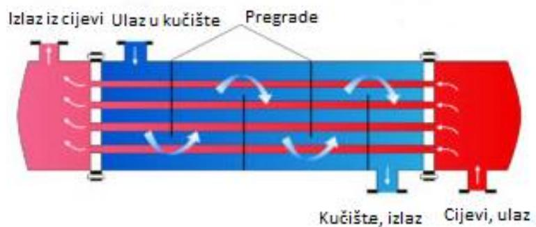
Slika 15. Kondenzator s plaštom i cijevima [10]
