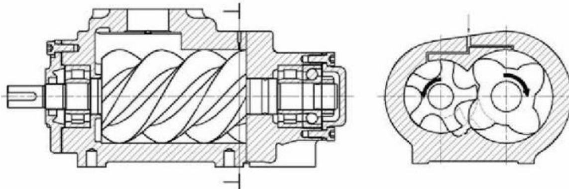
Slika 10. Prikaz vijčanog kompresora i rotorskog sloga [20]
