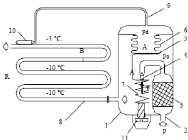
**1-kućište, 2-priklučak, 3-filtar, 4-igla venila, 5-jaram, 6-membrana, 7-opruga, 8-isparivač, 9-kapilarna cijev, 10-osjetnik temperature.**
