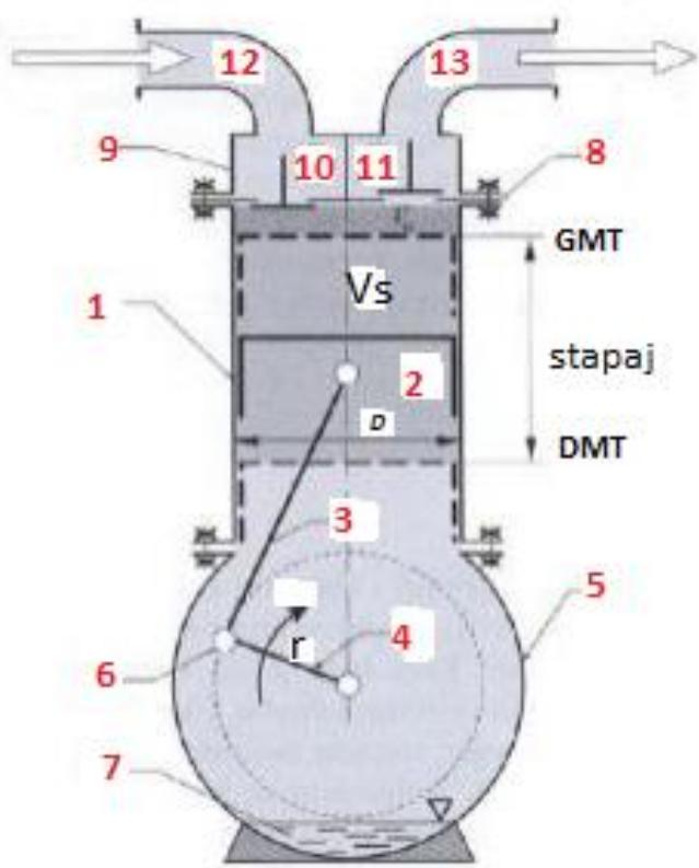
Slika 9. Klipni kompresor i glavne komponente [21]
