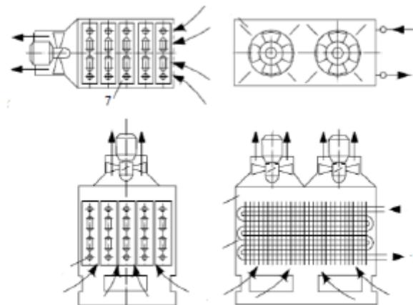
**Slika 12. Zrakom hlađeni kondenzator [12]**
