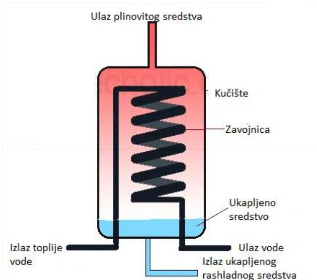
Slika 14. Kondenzator s plaštom i zavojnicom [10]
