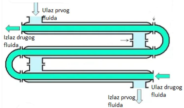
Slika 13. Cijevni tip kondenzatora [10]
