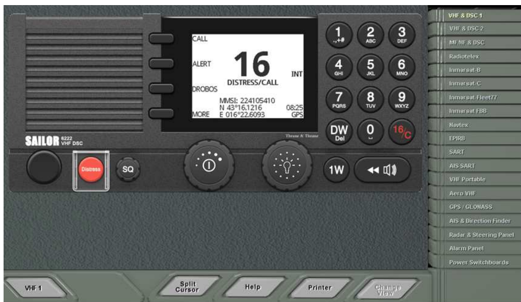
Slika 9. VHF DSC 1 na kanalu 16
