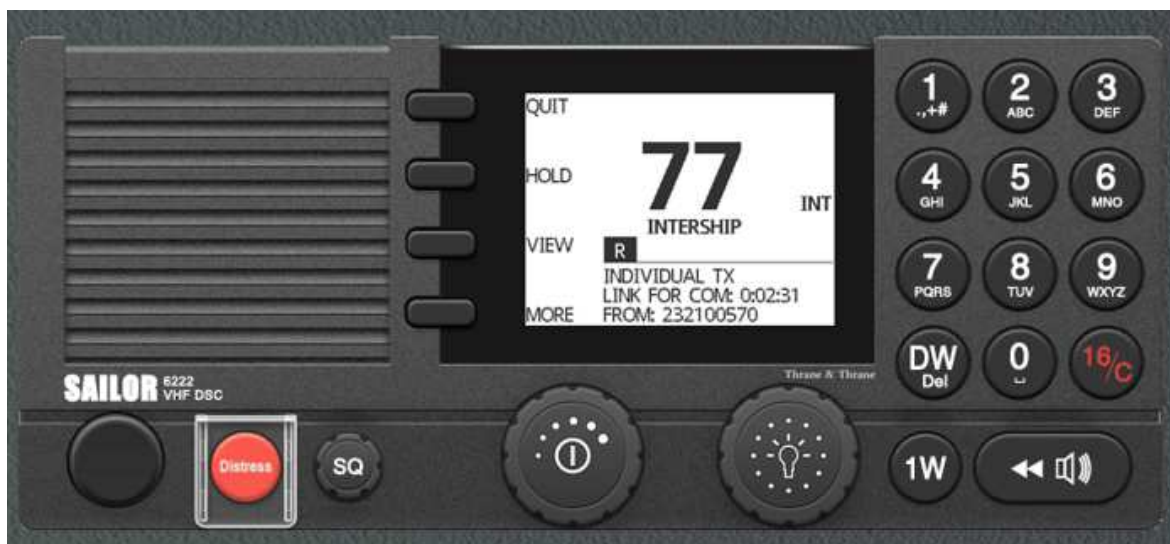
Slika 16. Uspostavljen poziv na početnoj radiostanici m/v Arcona na kanalu 77
