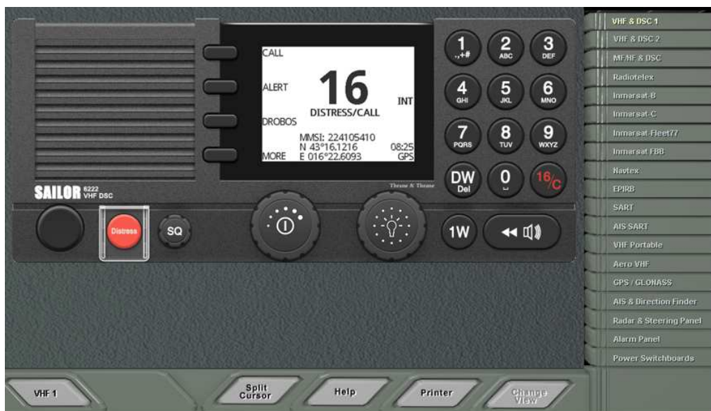
Slika 9. VHF DSC 1 na kanalu 16
