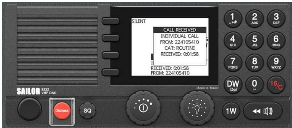
**Slika 13. VHF DSC uredaj brodske radiostanice m/v Glasgow prilikom zaprimanja poziva**
