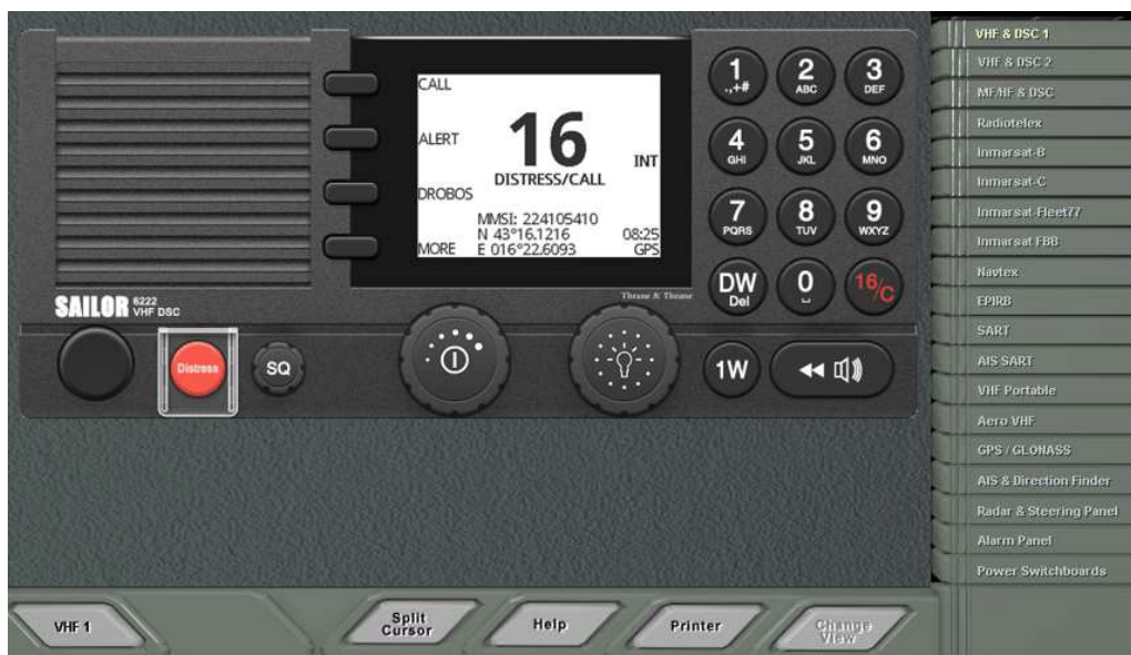
Slika 9. VHF DSC 1 na kanalu 16
