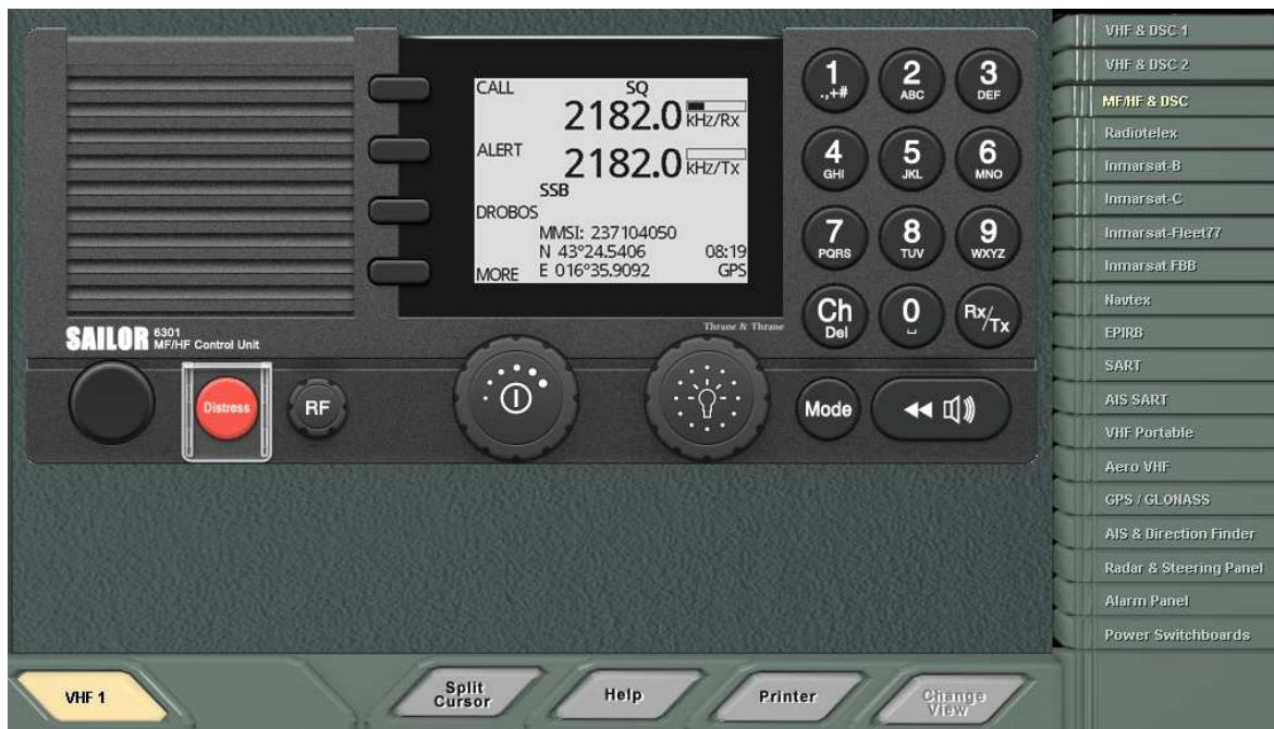
**Slika 25. Prikaz MF/HF & DSC uredaja na TRANSAS TGS 5000 simulatoru**
