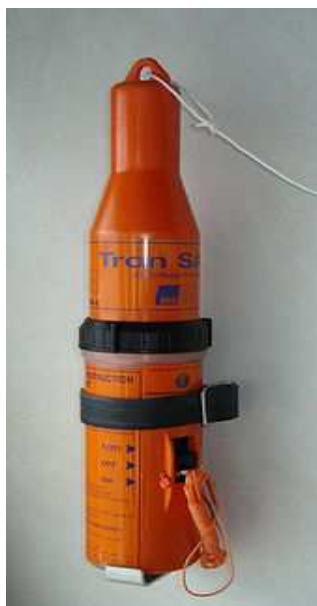
Slika 3. Standardni radarski transponder SART 9 GHz, proizvođača Jotron, na norveškom trajektu [6]
