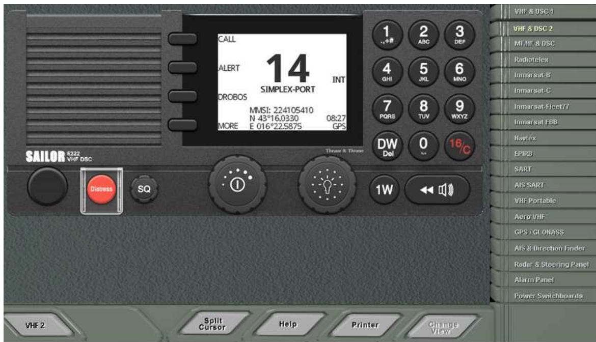
Slika 10. VHF DSC 2 na kanalu 14
